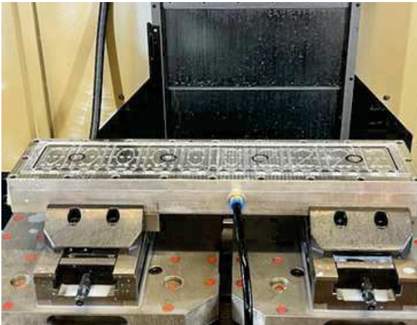
Fräsvorgang mit Vakuum
