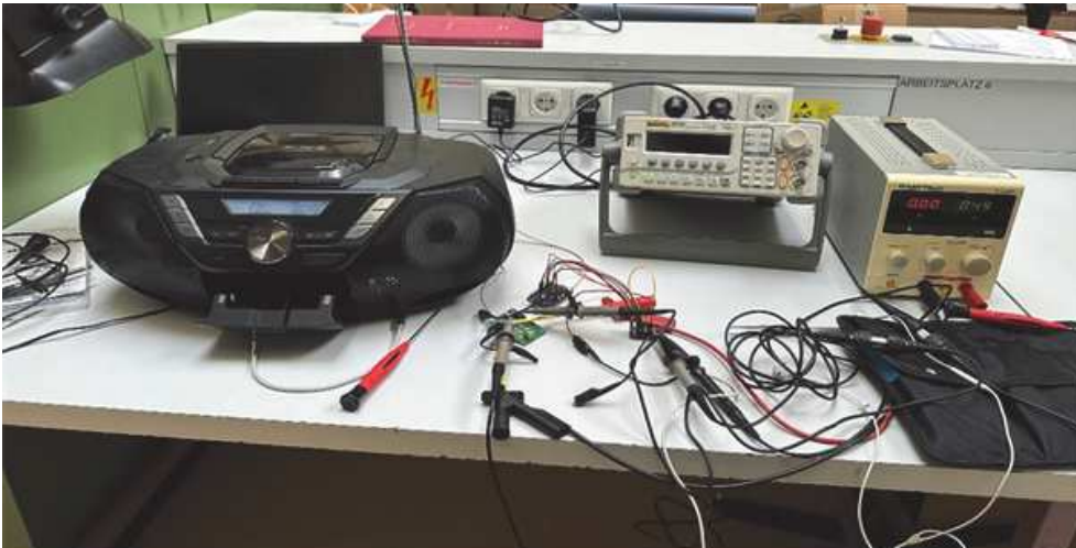
Funktionsaufbau des Bluetooth-FM-Transmitters
